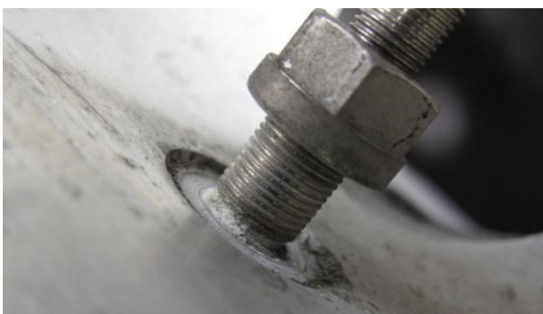
Oxidation auf T-Förmigen Dichtungsring
