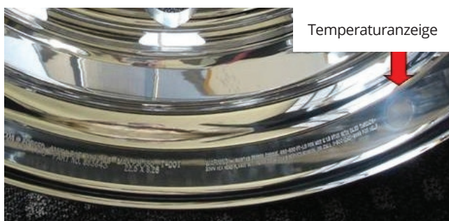
Abbildung 13-2 Hitzeindikator am Radflansch
